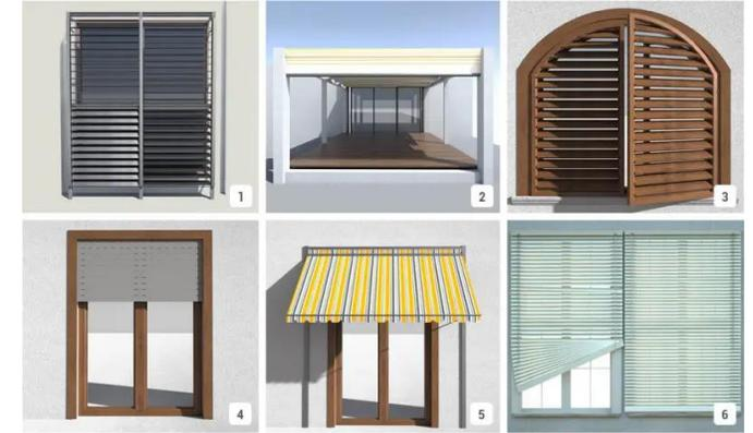
Le *chiusure oscuranti* non solo riducono la radiazione solare, ma apportano anche resistenza termica all'infisso. Esse possono essere inserite, a differenza delle schermature solari, per tutti gli orientamenti.
